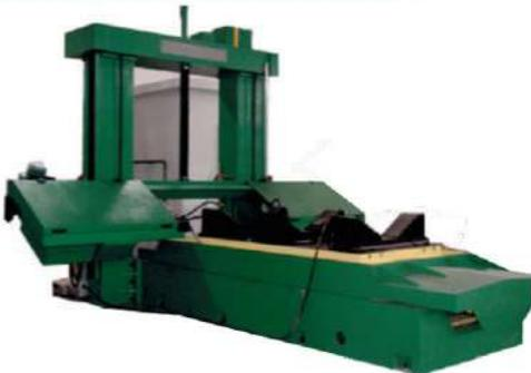
Станки предназначены для резки заготовок из жаропрочных, легированных сталей и сплавов, титана, вольфрама и других труднообрабатываемых механическими методами токопроводящих материалов.
