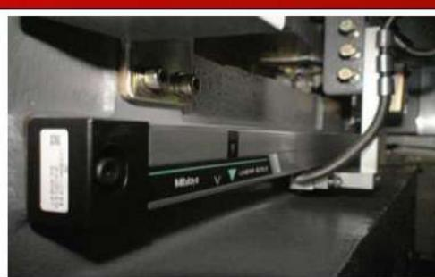
Оптические линейки по осям U,V
