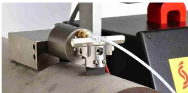
Мобильная установка для нанесения насечек, с целью проведения неразрушающего контроля
