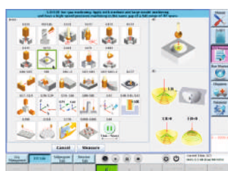
Функция определения параллельности электрода к заготовке
