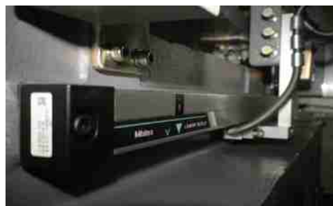
Оптические линейки по осям U,V
