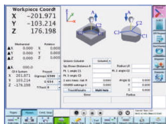
Поиск центра заготовки относительно 3 точек
