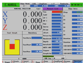
Окно моделирования процесса ЭО с возможностью наблюдать график позиции и перемещения инструмента
