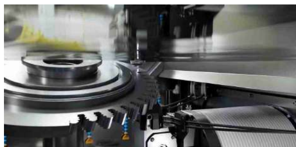
Макс. диаметр заготовки: 2000 мм Диаметр планшайбы: 500 мм Перемещения по осям X/Y/Z/U/V: 400/400/350/150/350 мм
