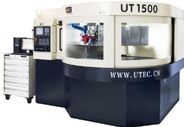
Все системы UTEC поставляются с 8 или 12 позиционным автоматическим сменщиком инструмента, рубщиком стружки, системой вытяжки стружки, набором инструмента и высококачественными алюминиевыми держателями заготовок.
